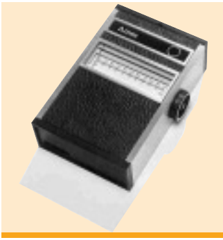
Figura 1. Ames Reflectance Meter® (Division Miles Laboratories Inc., Elkhart, Indiana, Estados Unidos): el primer reflectómetro, comercializado en 1970
